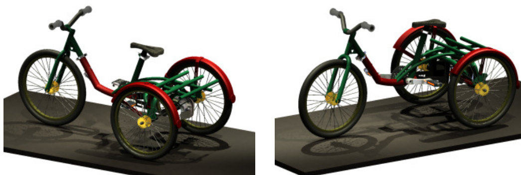
Rys.2. Projekt roweru trójkołowego dziecięcego z kołami pionowymi
