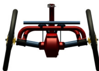
Rys.4. Położenie kół względem podłoża: a) pionowe, b) skośne
