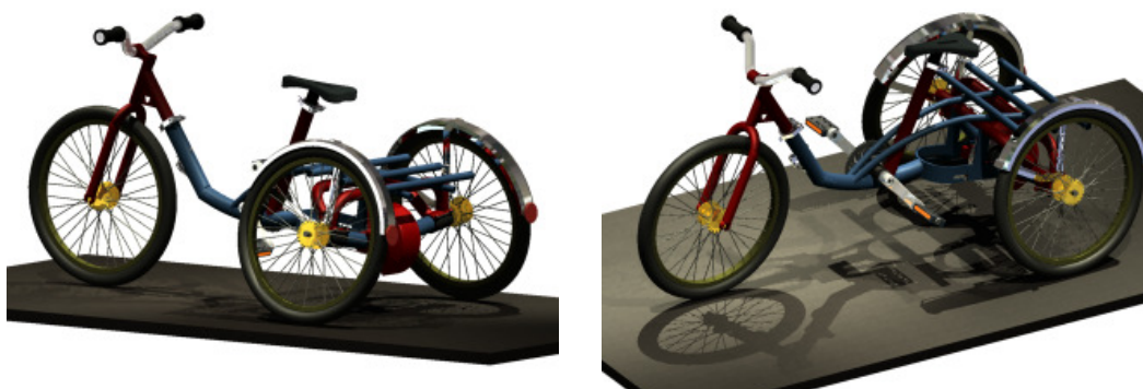
Rys.3. Projekt roweru trójkołowego dziecięcego z kołami skośnymi
