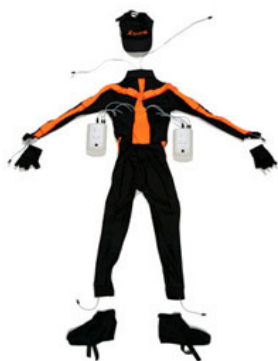
Rys. 4.A) Kombinezon Moven z wbudowanymi czujnikami inercyjnymi, B) okno programu Moven Studio
