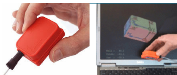
Rys. 2. Czujnik inercyjny MTx firmy Xsens oraz wizualizacja on-line odzwierciedlająca jego ruchy [13]
