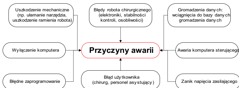
Rys.1. Przyczyny niebezpiecznych awarii robotów chirurgicznych. Wg [2]
