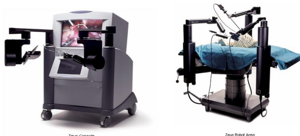
Rys.2. Telemanipulator medyczny Zeus [2]
