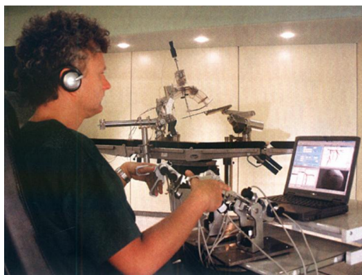
Rys.4. Telemanipulator medyczny RobIn Heart [1]
