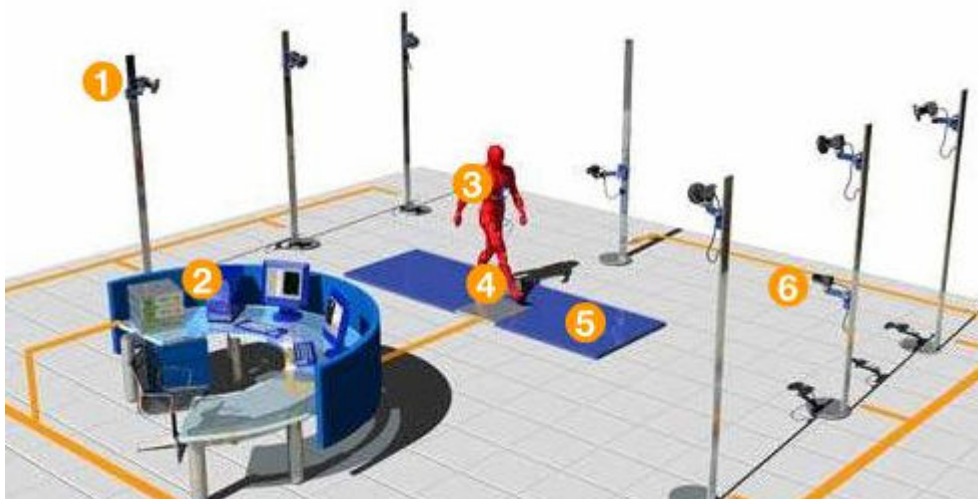
Rys. 4. Rozmieszczenie komponentów Sytemu BTS Smart (1 – kamery na podczterwień, 2 – stanowisko robocze, 3 – przenośny zestaw do EMG, 4 – markery, 5 – platforma dynamometryczna, 6 – kamery video) [8]
